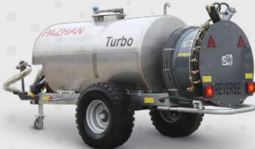
سمپاش ۲۰۰۰ لیتری اتومایزر استیل فن ریورس
